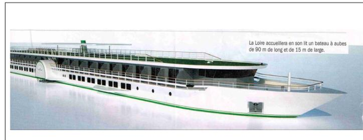
Ce navire géant pourra accueillir 96 passagers dans 48 cabines réparties sur les trois ponts, avec salle à manger, salon-bar et 9 postes d'équipage... Les concepteurs ont choisi une propulsion à aubes latérales actionnées par 2 moteurs diesel de 500 ch pour permettre une vitesse de croisière de 15 km/h et une navigation jusqu'à 1 m de profondeur.
