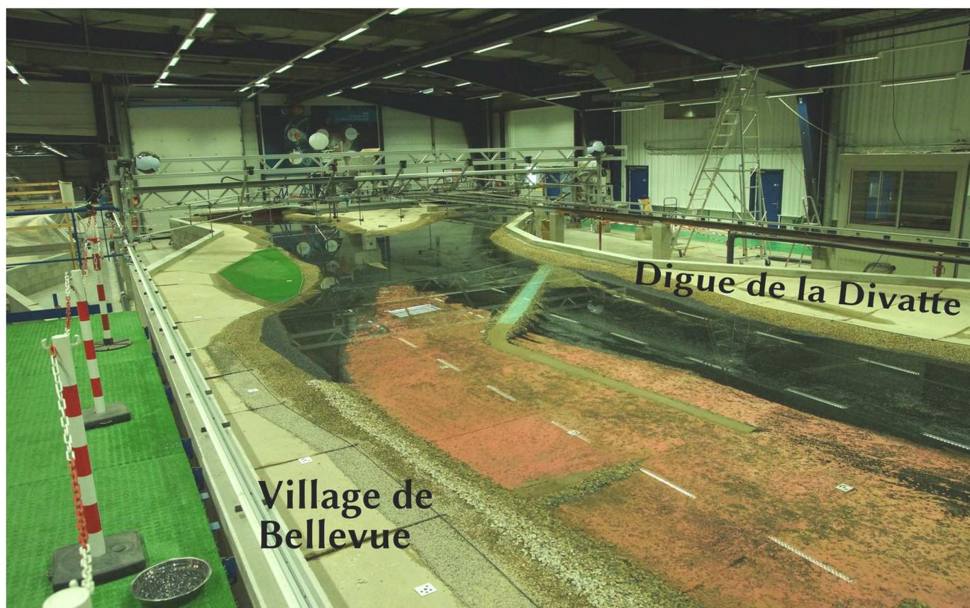
*Vu de la rive droite vers l'amont, le modèle physique avec l'ouvrage projeté : un digue submersible de 800 m de long déviant le chenal principal sur l'ancien seuil rocheux en bordure du village de Bellevue comme avant 1976... Cet ouvrage relèverait la ligne d'eau jusqu'à 1,70 m aux étiages de basse mer sans aggraver les risques d'inondation.*
