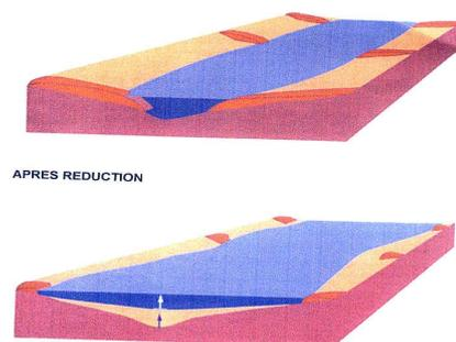
Principe du remodelage des épis pour ouvrir la section d'écoulement, remobiliser le sable et combler l'incision du lit (GIP LE)
