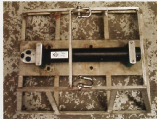
Photo d'un appareil de mesure de vitesse par ADCP
